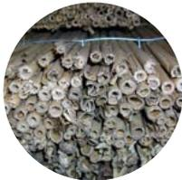
La canne per l'utilizzo in edilizia vengono raccolte già secche e poi legate insieme mediante filo di ferro zincato o filo di nylon; in tal modo le cavità interne rimangono integre e contengono aria ferma, ottima per l'isolamento termico.
